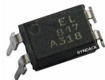
En la salida del optoacoplador **EL817**, el fototransistor no tiene la suficiente capacidad de activar una carga grande, por lo tanto se le añade 6 transistores **BC557 PNP** al circuito para amplificar la corriente lo suficiente para que la bobina del relé pueda activar los contactos sin ningún problema.
