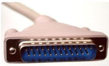
*Cable 25 hilos y conector macho DB25 aéreo.*
